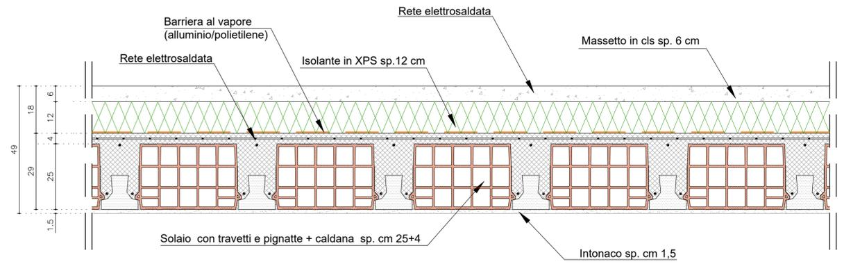
**PARTICOLARE 5 Solaio di Copertura SCALA 1:10**
